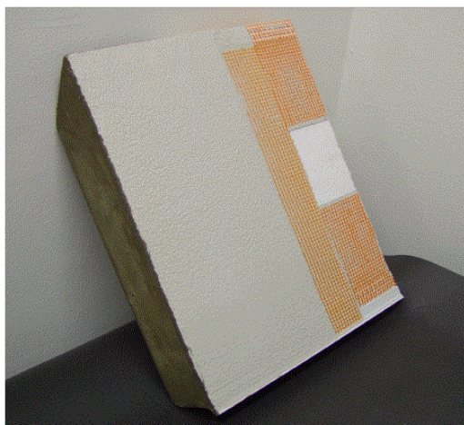
Bild 3: Schematisches Beispiel für einen geeigneten Prüfkörperaufbau.
