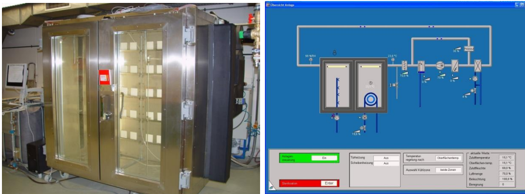
Bild.2: Photographische Ansicht der laufenden Schnellbewitterungsanlage (links) und Screenshot des Überwachungsprogramms (rechts).
