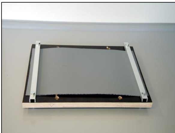
Abb.: Die Glasschale sitzt auf einer weichen Unterlage und wird über Holzdübel in Position gehalten. Die Dachfolie wird über zwei Aluprofile am Brett fixiert. Hierüber wird nach den Wasserwechseln eine präzise Positionierung des gleichen Folienbereichs erreicht.
