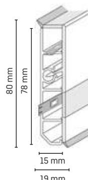
LED-Band oben (Light up) oder LED-Band unten (Light down) möglich
