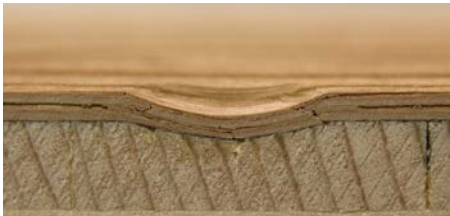
Herkömmliches Parkett mit Fichte-Mittellage (Deckschicht Eiche 3,6 mm)
