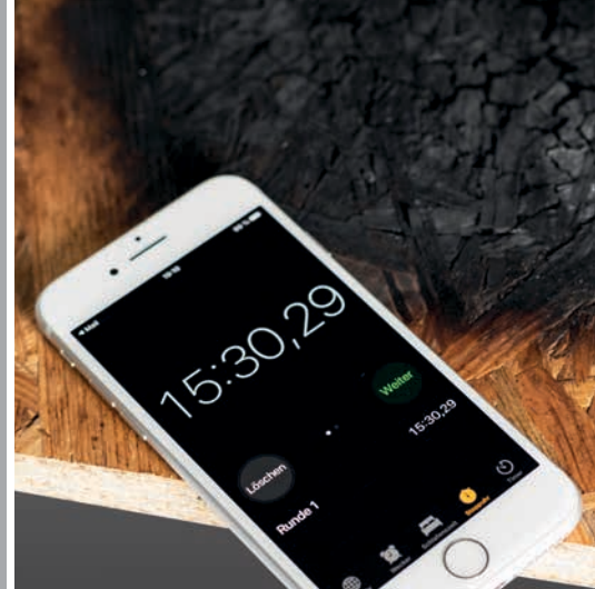
Nach 15 Minuten Beflammung ist nur eine verkohlte Oberfläche zu sehen
