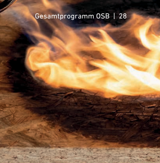
SWISS KRONO OSB/3 SF-B bildet durch Verkohlung eine feuerhemmende Schicht
