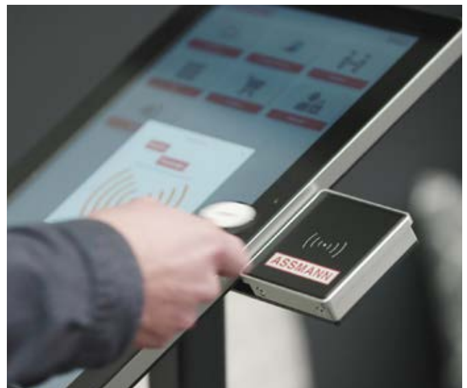
Log-In: Öffnung der Schließfächer mit RFID-Chipkarte
